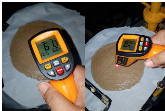
Gambar 3. Pengukuran suhu permukaan spreader menggunakan termometer inframerah ( thermogun )
