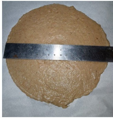
Gambar 4. Pengukuran diameter sebaran menggunakan penggaris
