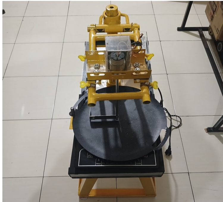
Gambar 1. Mesin penyebar fruit leather aplikatif berbasis motor DC
