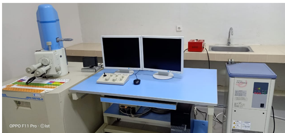
Gambar 5. Alat Uji SEM
