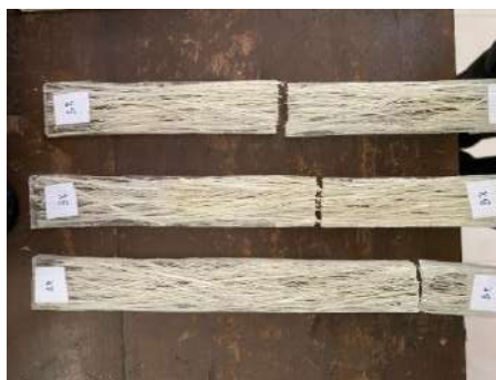
Gambar 9. Citra patahan spesimen setelah dilakukan pengujian tarik (sumber: dokumen pribadi)
